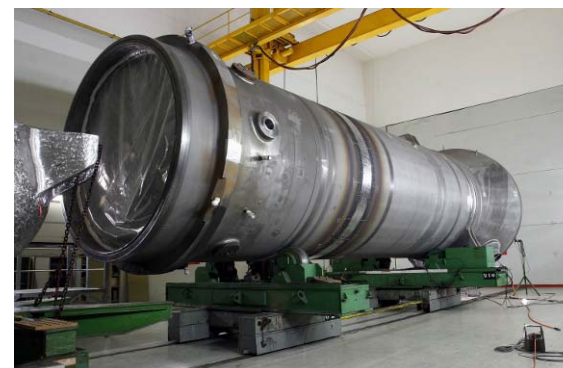
Générateur de vapeur
