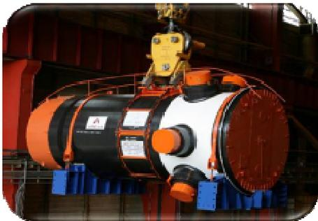
**1975** Mise en service de l'atelier Framatome St Marcel : fabrication de générateurs de vapeur et pressuriseurs
