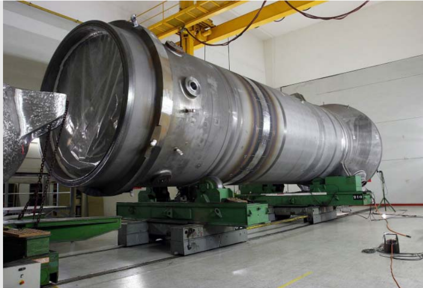
Fabrication des composants primaires à Chalon St Marcel : assemblage des parties inférieures des générateurs de vapeur
