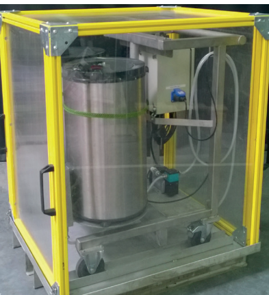
Unité de traitement dans son enceinte de confinement et de transport
