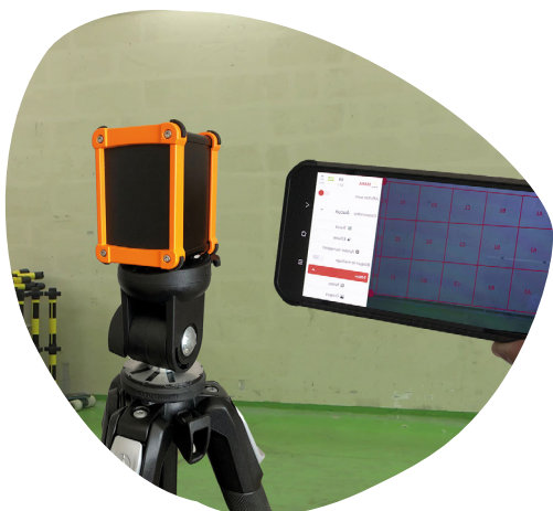
Déploiement de MARA sur le terrain : définition d'un maillage régulier sur la façade d'un mur
