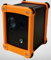
Boîtier MARA intégrant une caméra HD et un télémètre laser
