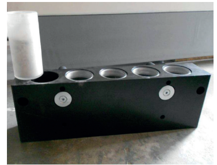
Magasin embarqué sur RODSY10+ pour le prélèvement de cinq carottes
