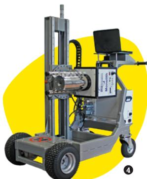
Exemple de chaîne de mesure gamma mobile manuelle utilisée pour la mesure de déchets ou de matériaux radioactifs.
