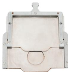
Tiroir en position ouverte. Position prise lors des vérifications périodiques de bon fonctionnement de la balise de détection de contamination atmosphérique.
