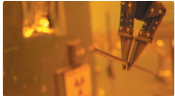
Télémanipulation de sources de rayonnement gamma utilisé pour étudier le comportement de matériaux sous irradiation © IRSN Saclay
