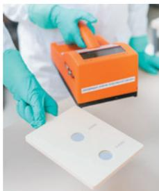
**Porte-source** pour sources alpha électro-déposées (type EAS) utilisées pour les balises EDGAR.
