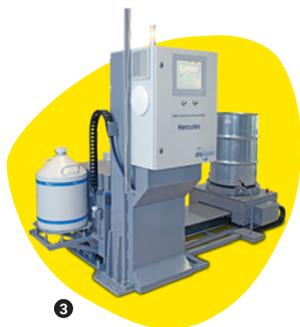
Exemple de chaîne de mesure gamma automatique utilisée pour la caractérisation des déchets radioactifs.
