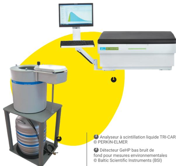
① Analyseur à scintillation liquide TRI-CARB™
