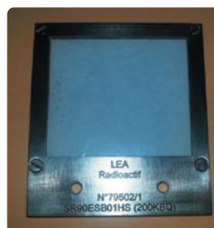
Source de dimension active 38 x 43 mm, dimension externe 44 x 49 mm montée sur un support inox spécifique
