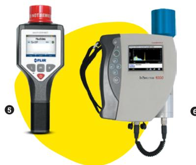
Exemples de spectromètres portables, utilisés lors de projets de démantèlement ou par les forces d'intervention type pompiers
