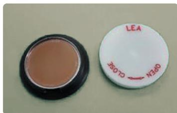
Source de diamètre actif 40 mm déposée dans la coupelle client de diamètre 47 mm
