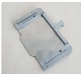
Tiroir en position fermée. Position prise en fonctionnement normal de la balise de détection de contamination atmosphérique. Le plateau est rentré, réalisant le rôle d'écran au flux alpha généré par la source.
