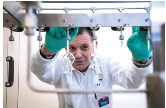
Remplissage d'une ampoule de  $^{85}\text{Kr}$  © LEA
