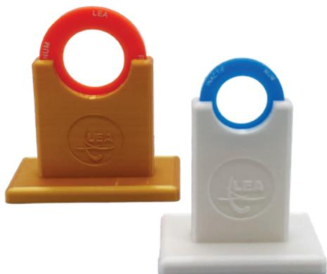
**Pinces** pour manipuler les sources afin d'éviter de déposer une pellicule de gras sur les sources alpha (ce qui aurait pour conséquence de dégrader le signal émergent).
