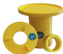
Centreurs modulaires 3 en 1, adapté à un capot de détecteur GeHP de 78 mm de diamètre, pour le positionnement de 3 géométries différentes : filtre de diamètre 52 mm, filtre de diamètre 120 mm ou flacon SG50.
