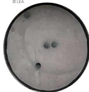
Exemple de fût étalon avec matrice mousse et emplacements pour insérer des sources tubes
