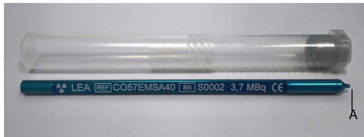
Figura 3: Presentazione della matita/penna marcatore ^{57}\text{Co} (A = deposito radioattivo)
