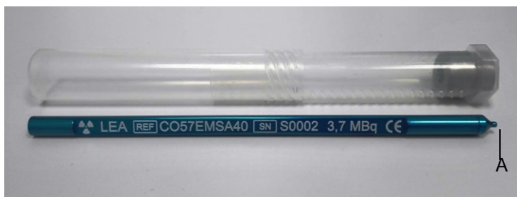
Figure 1 : présentation du stylo marqueur ^{57}\text{Co} (A = dépôt radioactif)
