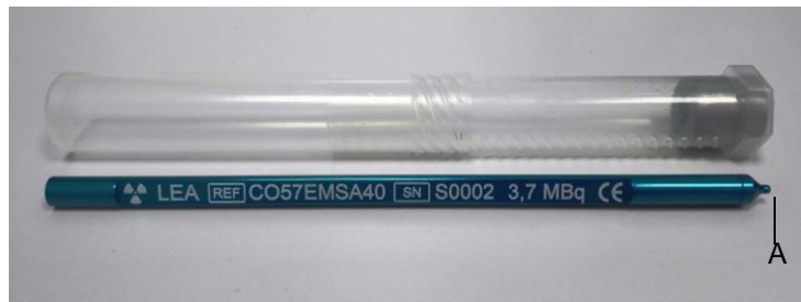
Gráfico 4 : presentación del rotulador ^{57}\text{Co} (A = depósito radioactivo)
