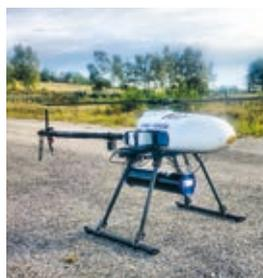
Les drones peuvent aussi embarquer des ondes radiométriques pour la réalisation de campagnes d'exploration géophysiques avec une précision et des gains de temps importants.
