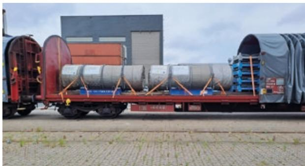
▲ Transport ferroviaire de cylindres d'UF<sub>6</sub>
