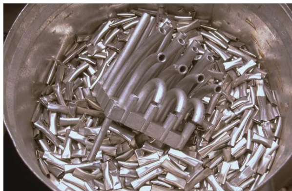
Figure 8 : Déchets de structure (coques et embouts) avant compactage
