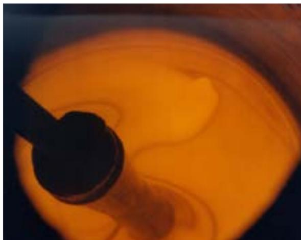
Photo 20 : verre en fusion dans le creuset froid
