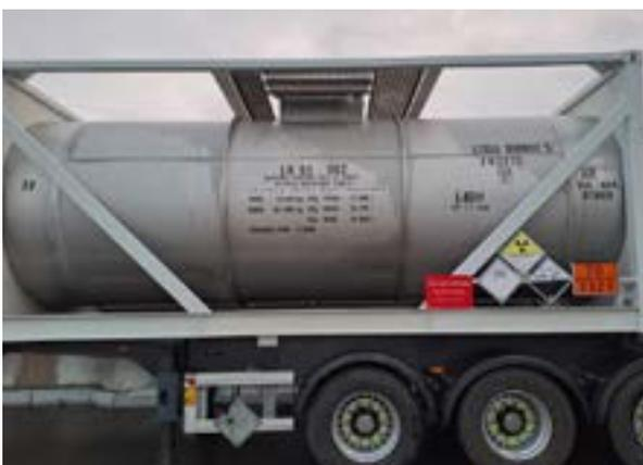
Photo 12 : citerne LR65 utilisé pour le transfert des effluents
