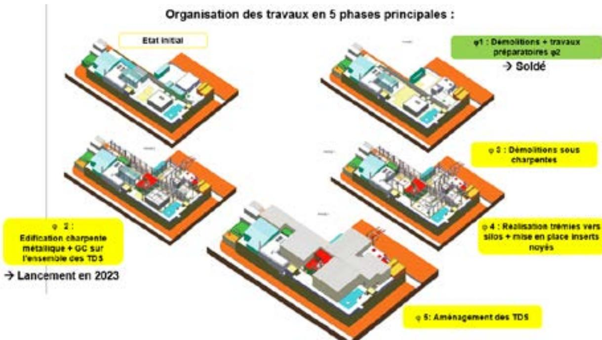
Schéma 16 : phasage des Travaux Génie-Civil et Charpente sur Bâtiment 114.1
