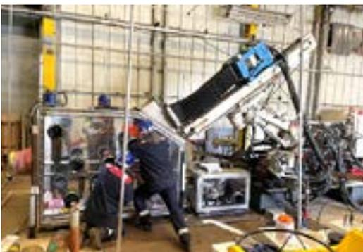
Photo 14 : foreuse réalisant les prises d'échantillons de terres et gravats dans la fosse 43 du silo
