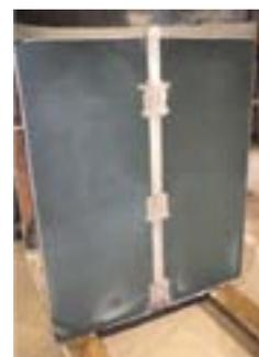
Photo 7 : Fût de fines et résines cimentées après découpe issu de l'essai de qualification
