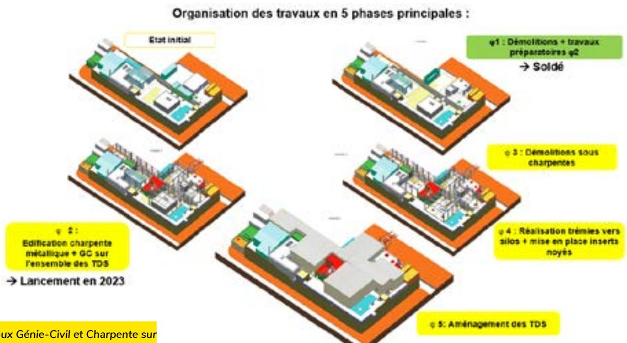
Schéma 16 : phasage des Travaux Génie-Civil et Charpente sur Bâtiment 114.1
