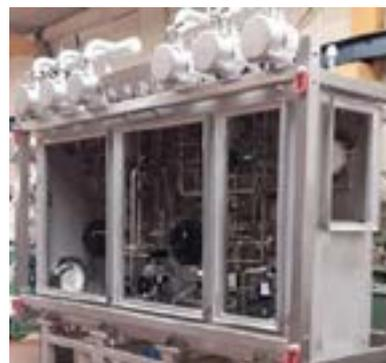
Photo 25 : construction de la boîte à gants des équipements de transfert
