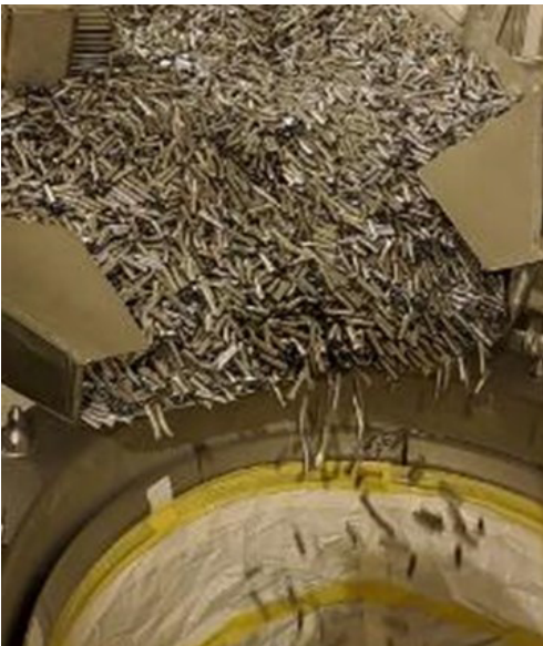
Photos 5 : essais d'ensemble mécaniques de la cellule de reprise : déversement d'un curseur de coques et remplissage d'un panier ECE en coques et embouts au poste de mesure nucléaire
