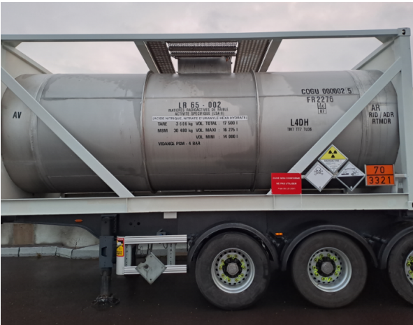
Photo 8 : citerne LR65 utilisée pour le transfert des effluents
