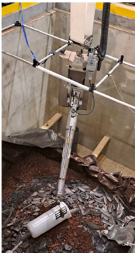
Photo 13 : Essais préhension poubelle AT1 sur maquette
