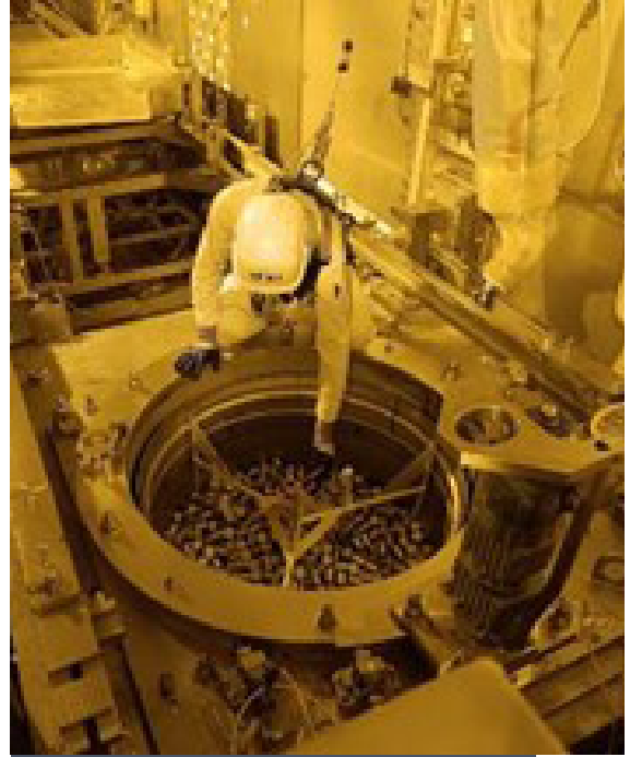
Photo 4 : étalonnage du poste de mesures nucléaires de la future cellule de reprise
