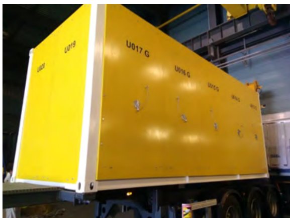
Photo 8 : citerne LR65, équipée de ses protections radiologiques, utilisée pour le transfert des effluents
