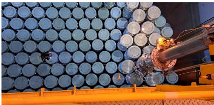
Photos 6 et 7 : organisation anticipée des curseurs de coques en vue de la mise en service de la cellule de reprise
