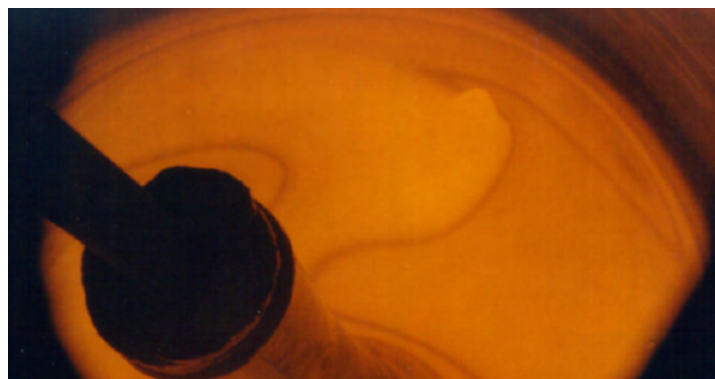
Photo 20 : verre en fusion dans le creuset froid
