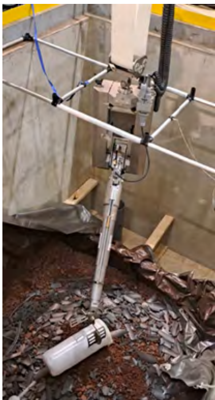
Photo 13 : essais préhension poubelle AT1 sur maquette
